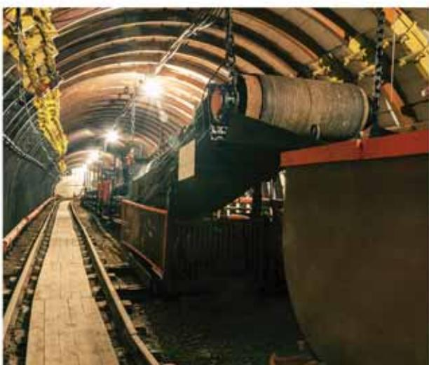
طراحی، تامین و ساخت انواع وینچ مورد استفاده در صنعت استخراج و فرآوری تناز بالابری بالا توانم با طول بالای سیم بکسل به همراه محیط های سخت کاری باعث گردیده است که این وینچ ها در نوع خود کاملاً سفارشی طراحی و ساخته شوند.
