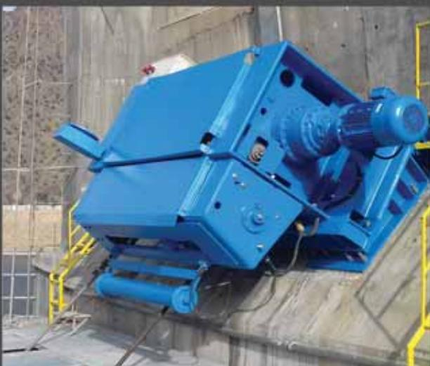
طراحی، تامین و ساخت انواع وینچ برای بالابری انواع دریچه های سد و سایر تجهیزات نیروگاهی که با توجه به کاربری این صنعت، عموماً وینچ ها با ارتفاع های بالابری خاص و بلند مورد نیاز است.
